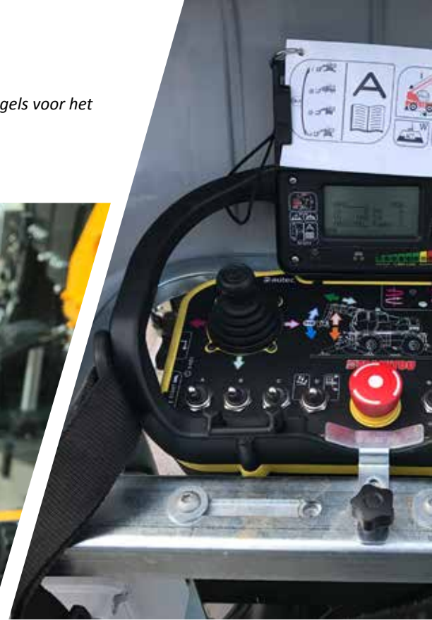
Werkbak voorzien van bedieningskast
